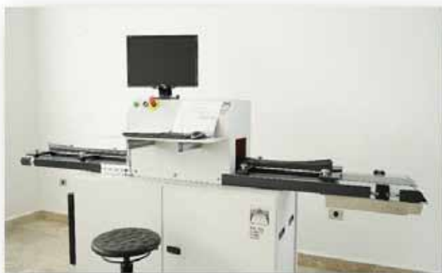
● Fig. 7 Caracterización y análisis de propiedades físicas y químicas en núcleos. Sistema de rayos gama e imágenes digitales en núcleos de perforación
