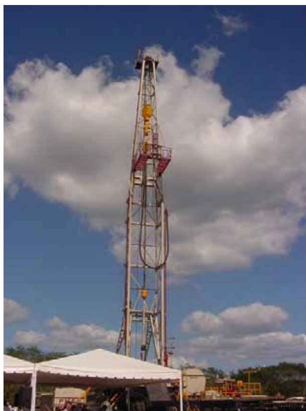
● Fig. 3 Vista de la torre de perforación del pozo Yaxcopoil-1 (Yax-1) del programa de perforaciones científicas Chicxulub. En la torre se instala el sistema de recuperación de núcleos y los sistemas de registros geofísicos
