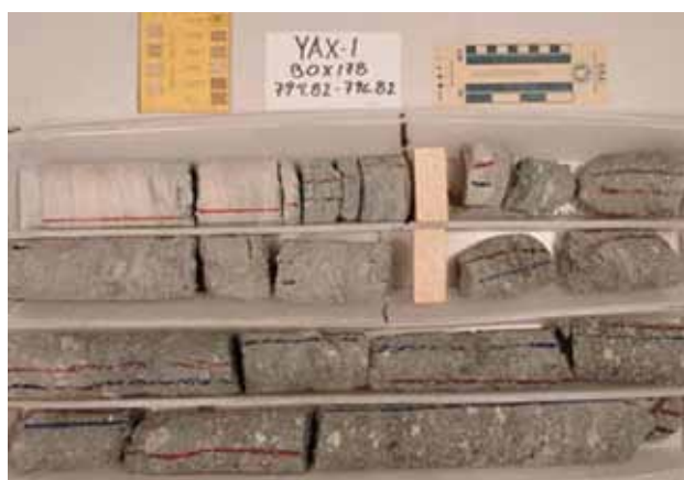
● Fig. 8 Núcleos en el contacto entre las brechas de impacto y los sedimentos carbonatados en el pozo Yaxcopoil-1
